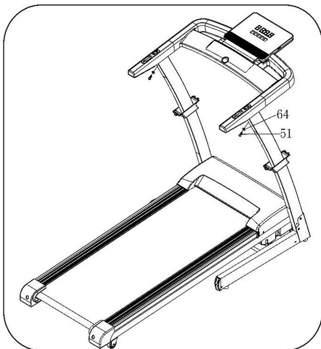
1. Придерживая кронштейн компьютера зафиксируйте компьютер на стойке с помощью шестигранного ключа на 5 (12), болта (51) и стопорной шайбы, как показано на рисунке слева.
