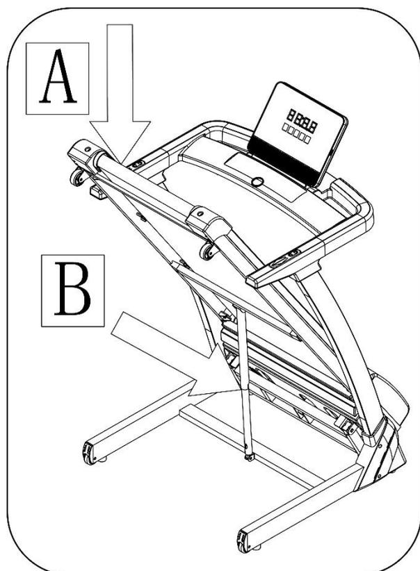
Придерживая раму в положении А, резко нажмите на фиксирующую трубку В, после этого основная рама опустится автоматически.
