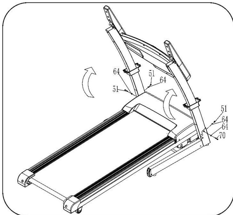
1. При помощи шестиранника № 5 (12), болта (70) и стопорной шайбы (64) закрепите правую стойку на основной раме.
