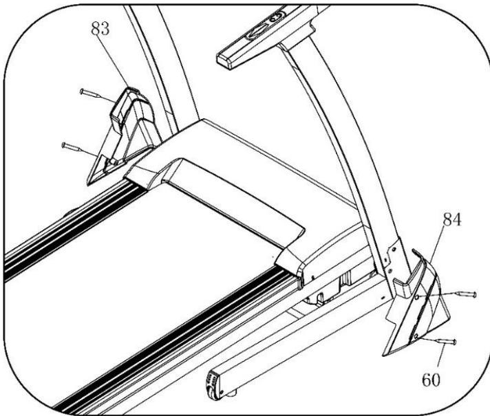
С помощью гаечного ключа с отверткой (73), винта (60), зафиксируйте левую и правую панель (83, 84) на левой и правой сторонах основной рамы соответственно
