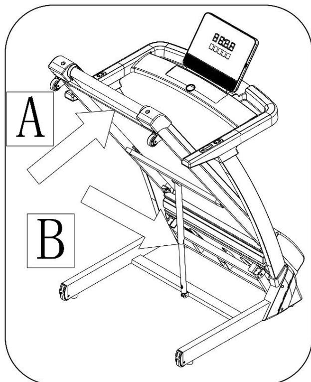
Подтяните основную раму в положение А, пока не услышите характерный звук — он означает, фиксацию конструкции пневматической фиксирующей трубкой В.
